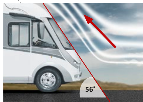
Frontale tridimensionale, angolo di incidenza piatto = minore resistenza dell'aria e riduzione del consumo di carburante
