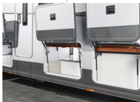
Altri vani di carico esterni nel doppio pavimento con accumulatore climatico, con grande sportello esterno.
