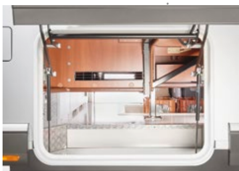
Vano di stivaggio "jumbo space", abbassato lateralmente, accesso dall'esterno tramite sportelli in stile bus a parallelogramma, dall'interno: attraverso la panca laterale e il gruppo sedute. Vano di stivaggio passante centrale, illuminato.
