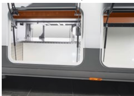
Vano di stivaggio nel doppio pavimento "mega space" con tecnologia a parallelogramma per un comodo accesso nei vani di stivaggio incassati nel doppio pavimento, vano di stivaggio centrale passante nel doppio pavimento, illuminato
