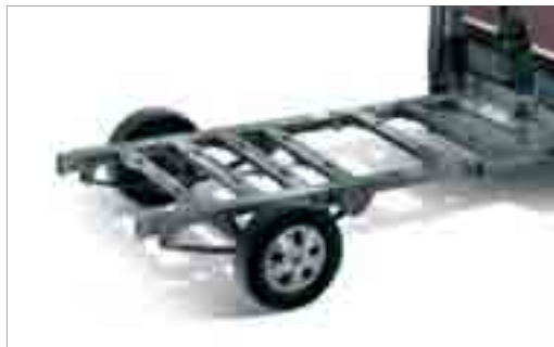
+ Fiat Breitspur-Tiefrahmenchassis für sichere Fahreigenschaften
