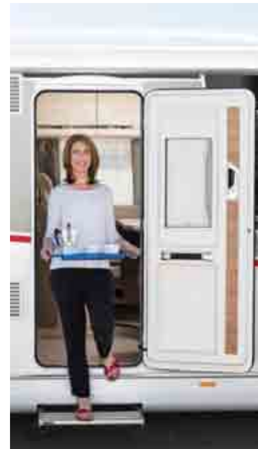
+ 70 cm breite Aufbauartüre (außer T/I 1) mit Fliegengitter-Jalousie
