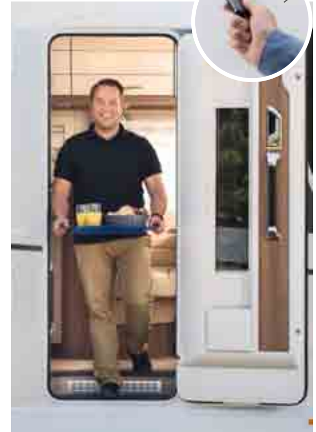
+ Extrabreite Wohnraumdüre (70 cm) mit sicherer 2-Punkt-Verriegelung, Fenster und Fliegengitter-Jalousie. Auf Wunsch mit Zentralverriegelung erhältlich
