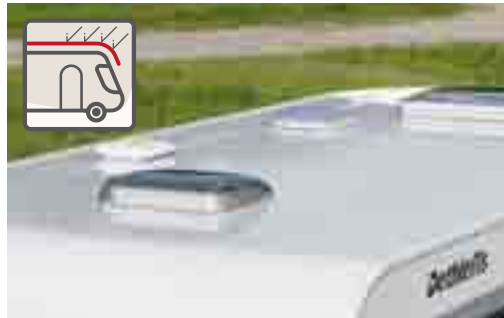
+ Gut geschützt vor Hagel: widerstandsfähiges GFK-Dach
