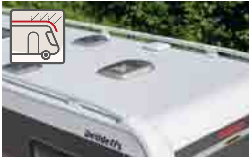
+ Gut geschützt vor Hagel: widerstandsfähiges GFK-Dach
