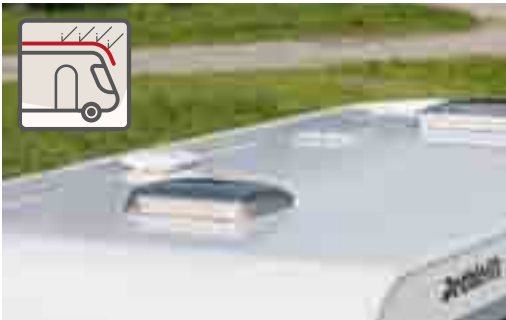
+ Gut geschützt vor Hagel: widerstandsfähiges GFK-Dach
