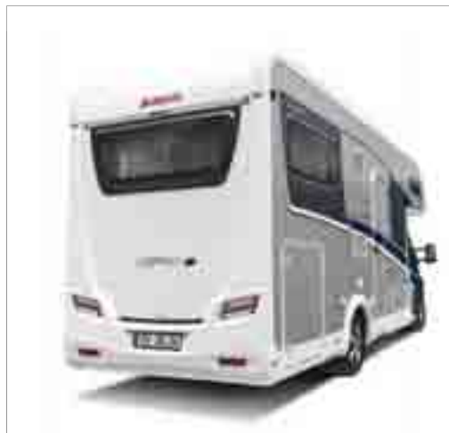
+ Reparaturfreundlich: das mehrteilige Heck mit stromsparenden LED-Rückleuchten
