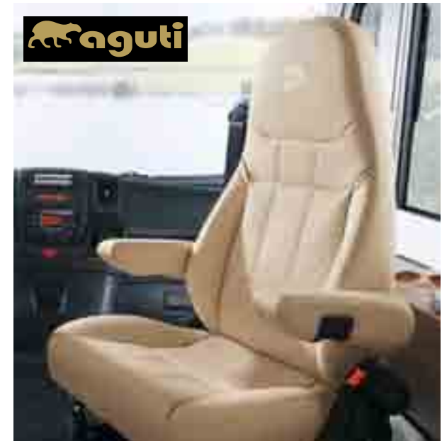
+ In Integrierten verbauen wir hochwertige Aguti Pilotensitze mit integriertem 3-Punkt-Sicherheitsgurt, der einen optimalen Gurtverlauf und maximale Bewegungsfreiheit sicherstellt
