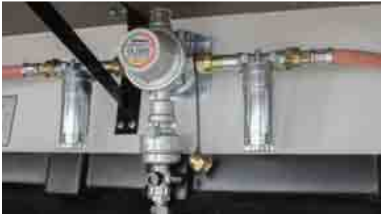
+ Duocontrol mit Crashsensor unterbricht die Gaszufuhr im Falle eines Aufpralls
