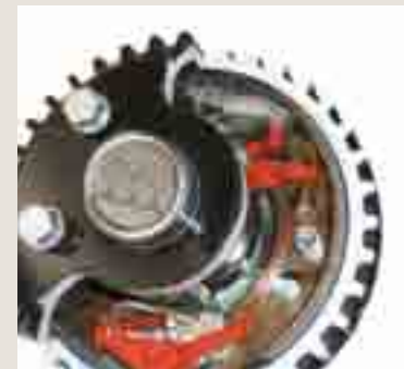
+ Die AL-KO AAA Bremse sorgt für stets optimal eingestellte Bremsen
