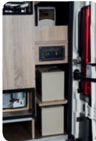
Due batterie di servizio al gel AGM 80 A (una per Xcape e Xcape XL)
