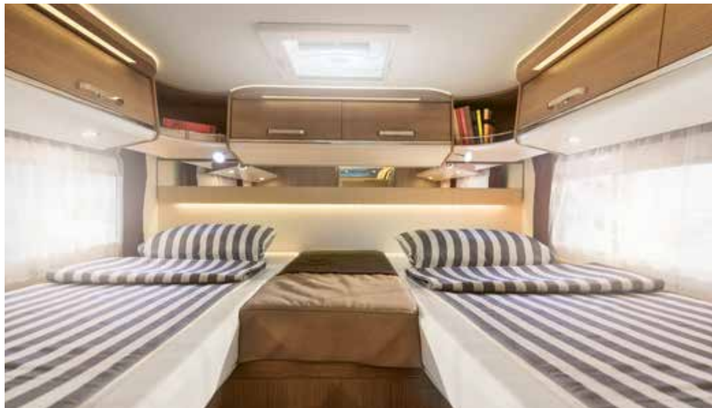
^ Grundriss Längseinzelbetten mit Liegemaß 195 x 82/119 cm. Modelle 440 LE und 460.
