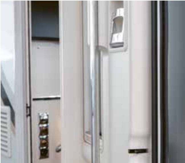
Aufbautür mit Anschlagspuffer und Sicherheitsverriegelung; Aufbautüreinstieg beheizt
