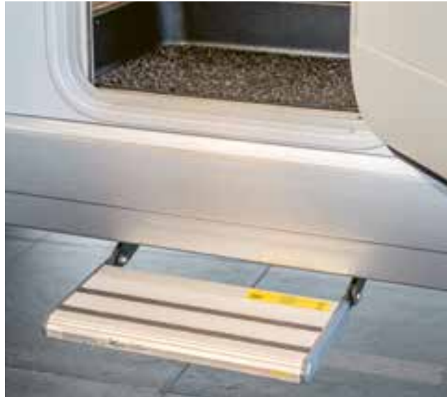
Elektrisch ausfahrbare Einstiegsstufe mit zusätzlicher Bedienung über das Fahrerhaus, inklusive Warnsummer
