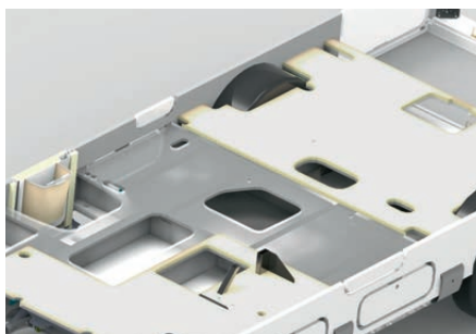
Il doppio pavimento RAPIDO è costruito su telaio ribassato AL-KO: l'abbassamento del telaio garantisce una perfetta stabilità di guida.
