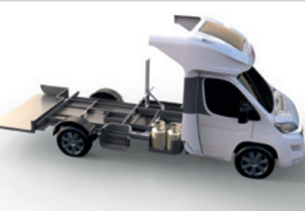
A) Struttura di rinforzo in acciaio composito.
