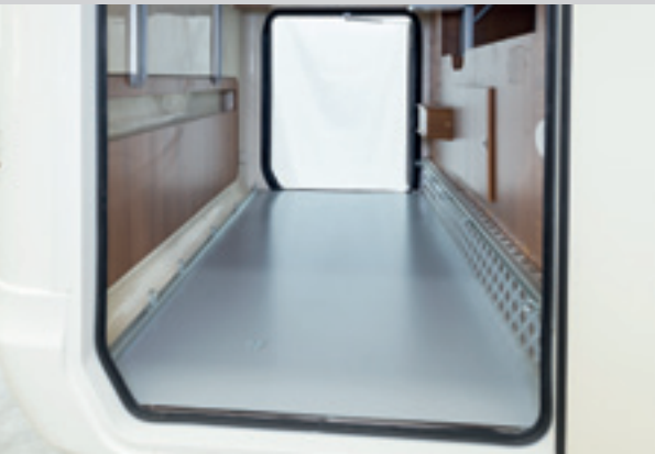
D) Pavimento garage con pannello sandwich per maggiore rigidità e coibentazione
