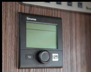
■ Comando comfort riscaldamento
