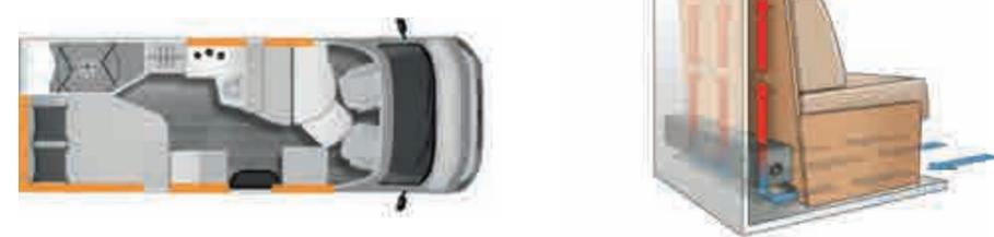
Die Warmwasserheizung verwöhnt mit gleichmäßiger Wärmeverteilung, wenig Energieverbrauch und flüsterleisem Betrieb. An den Außenwänden platzierte Konvektoren erwärmen die Luft sowie Wände und Möbel. So wird eine „Luftsperre“ erzeugt, die Kälte von den Fenstern fernhält. Hinterlüftete Stauschränke unterstützen zusätzlich die optimale Luftströmung zur Decke, bis sie erneut durch die Konvektoren erwärmt wird.
