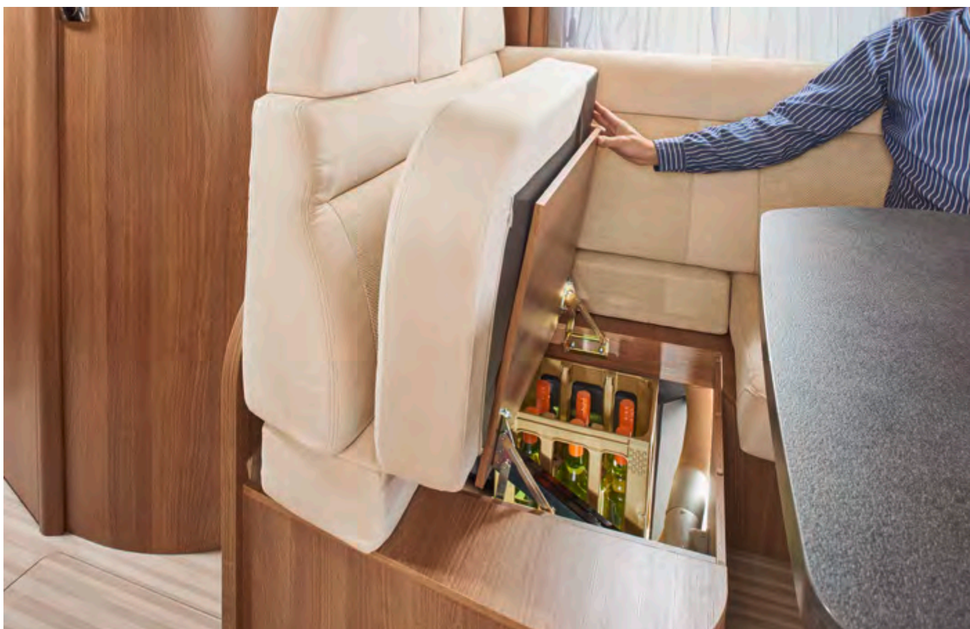
Sitzbankdeckel zum Doppelbodenstauraum mit Patentbeschlag, einfaches Öffnen ohne Polster entfernen
