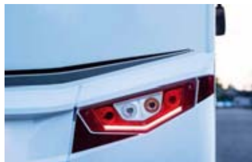
+ Markant und sicher: Integral-Rückleuchten mit LED-Nachtfahrlicht
