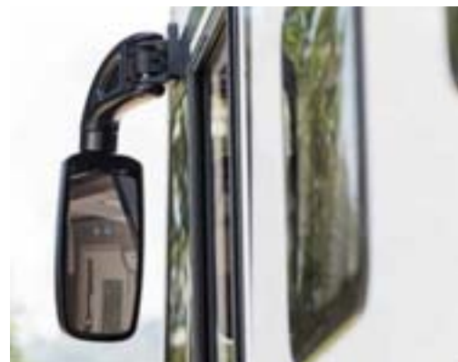
+ Reisebus-typisch: hängend montierte Spiegel für ein ungestörtes Blickfeld
