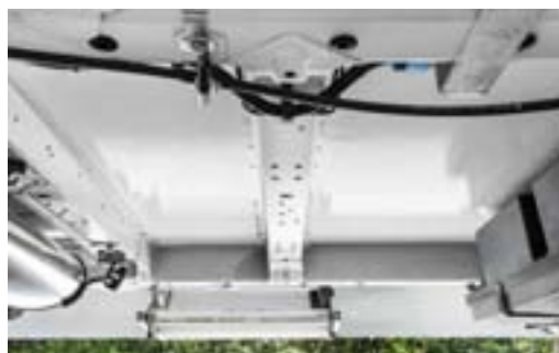
+ Holzfreie, verrottungssichere Lifetime-Smart Bodenkonstruktion (GFK-verkleidet)
