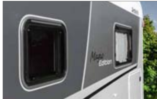
+ Sicher und gut isolierend: die dunklen Rahmenfenster
