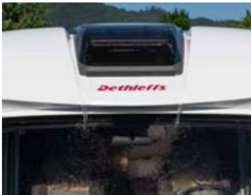
+ Wasserkänäle führen Regenwasser gezielt auf Frontscheibe und Heckbauch ab
