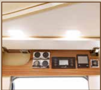
CENTRALE DI BORDO Tutti i dispositivi di comando elettrici sono nascosti dietro uno sportello al di sopra della porta della cellula.
