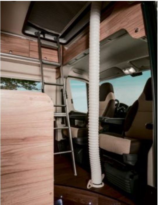
Ein optionaler Warmluftschlauch dient der Beheizung des Bereichs im Aufstelldach beim HYMERCAR.
