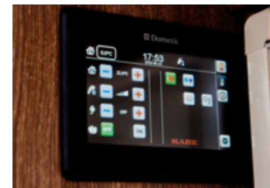
All information och styrning gällande värme visas på en egen sida. Här höjer och sänker du värmen smidigt med digitala skjutreglage.
