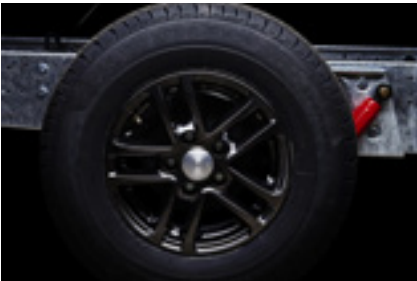
Däcken och kopplingen. Däck på enkelaxlade vagnar är av typ 8-lagers däck. Boggievagnar har 14" lågprofil däck. Alla vagnar har friktionskoppling.
