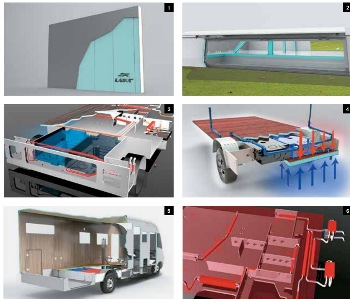
**1. Materiale coibente.** Grazie all'impiego dello Styrofoam ad alta densità per isolare pareti, pavimento, tetto e per gli sportelli del garage, i veicoli Laika sono utilizzabili in qualsiasi situazione climatica.
