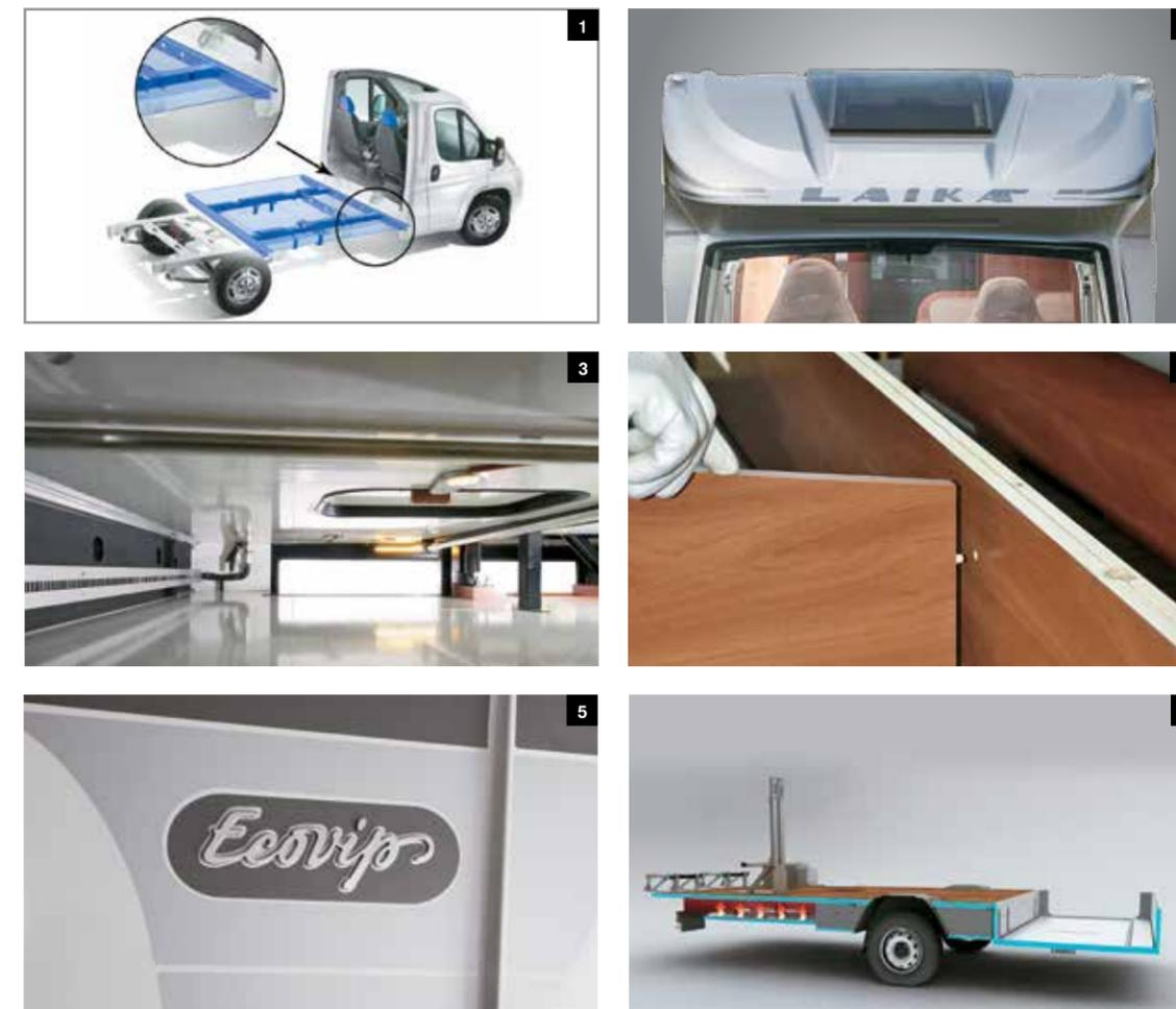
**1. Controtelaio zincato a caldo.** La presenza di questo controtelaio aumenta la robustezza e la tenuta fra chassis e cellula (esclusa serie Ecovip 100).
