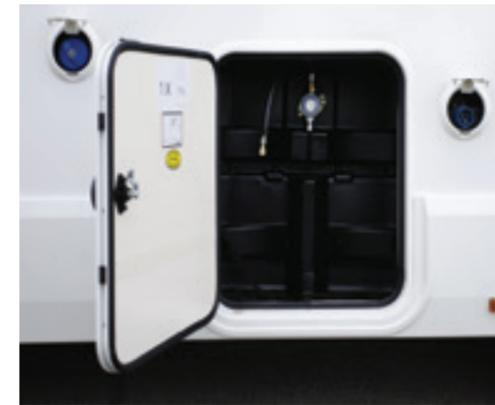
**Gavone bombole gas ribassato** in un apposito gavone che non toglie spazio alla cucina. La posizione ribassata facilita inoltre la sostituzione delle bombole del gas esaurite.
