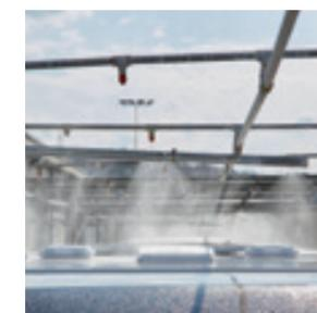
Test di impermeabilizzazione contro le infiltrazioni al 100% dei veicoli usciti di produzione, prima della consegna.
