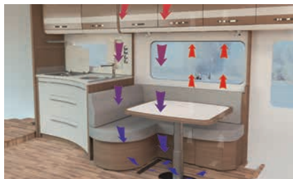
» Sistema AirPlus per la retroventilazione dei pensili
