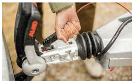
» Sistema di antisbandamento AKS
