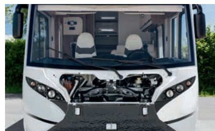
» I: Assistenza facilitata: grande apertura del vano motore per un comodo accesso
