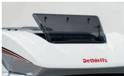
» T: Grande finestra apribile nel cupolino della cabina di guida
