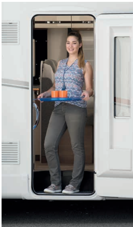
» Porta d'accesso larga 70 cm con gradino incassato, finestra e chiusura centralizzata
