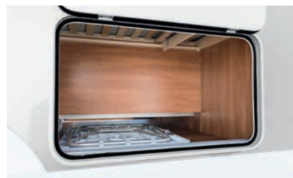
» T / I 7017: possibilità di carico passante sotto i letti singoli (aperture: 95 x 55 cm)
