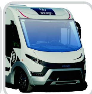
PARABREZZA TERMICO Parabrezza doppia funzione: sbrinatori in inverno e protezione del calore solare in estate (OPT Magnum)
