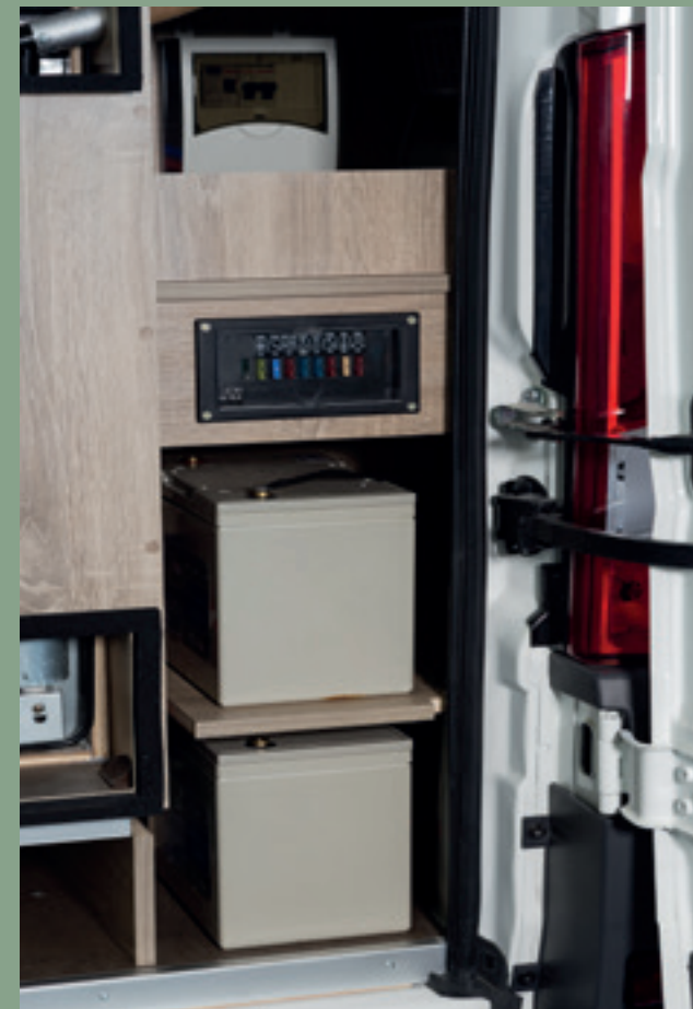
DUE BATTERIE DI SERVIZIO AL GEL AGM 80 A (UNA PER XCAPE XL)
