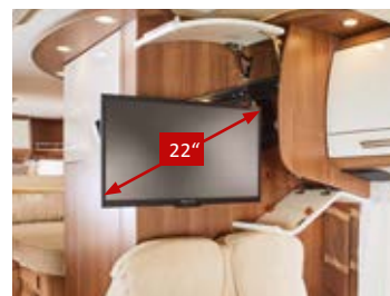
▲ Sistema di estrazione schermo TV sopra il gruppo sedute
