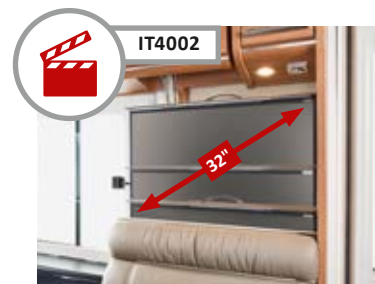
▲ Sistema di estrazione dello schermo TV dietro lo schienale della panca laterale
