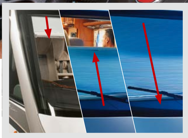
▲ Tendina plissettata isolante multifunzione per parabrezza a scorrimento orizzontale, con funzione di riparo dal sole, dagli sguardi indiscreti e oscurante con isolamento
