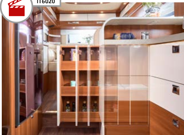
▲ Piano della cucina rialzato con grande armadio per le scorte e porta scorrevole a movimento contrapposto, la superficie è un'estensione del piano di lavoro
