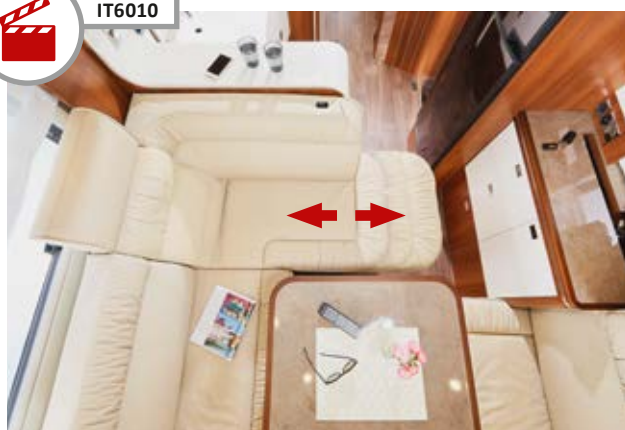
▲ Poltrona per guardare la TV a estrazione elettrica con adeguamento automatico dell'inclinazione dello schienale, tappezzeria pelle avorio
