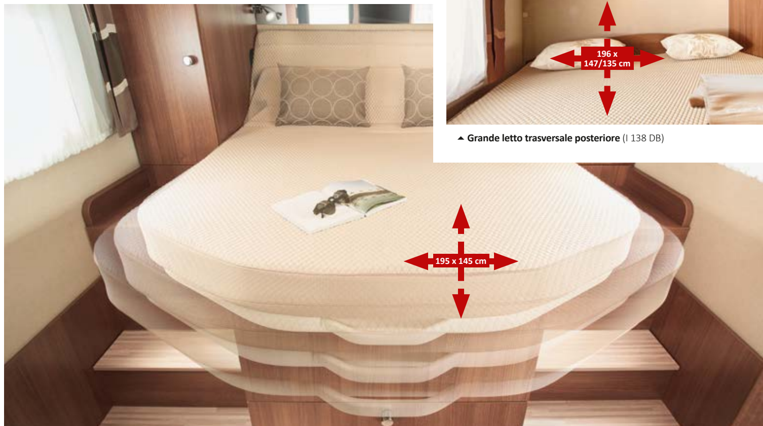
▲ Con richiesta di brevetto: superficie del letto spostabile di 30 cm per passare comodamente da posizione giorno a posizione notte (I 144 QB)
