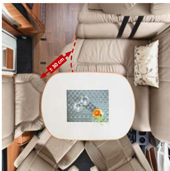
▲ Gruppo sedute a L con panca laterale optional con sponda a L più corta per allargare il passaggio verso la cabina di guida (non per I 5.3 QB SL e i modelli XL)
