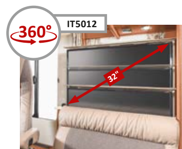
▲ Sistema di estrazione per schermo TV da 32" dietro lo schienale della panca laterale
