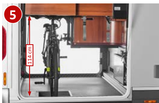
▲ Garage posteriore liner-for-two 53 con alloggiamento ruota/estensione dell'altezza volante su Fiat Ducato AL-KO
