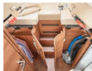
▲ Armadi guardaroba sotto i letti singoli longitudinali con funzione di sollevamento
