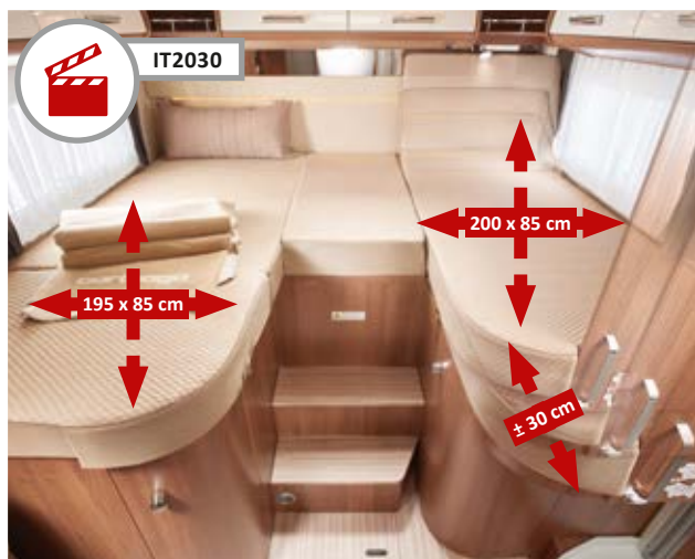
▲ Con richiesta di brevetto: letto spostabile di 30 cm per passare comodamente da posizione giorno a posizione notte (I 144 LE)
