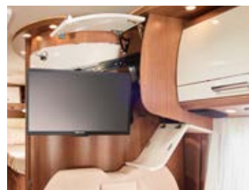
▲ Sistema di estrazione schermo TV nell'armadio pensile sopra il gruppo sedute
