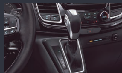
Boîte de vitesses à transmission automatique SelectShift 6 rapports, peut aussi être utilisée en mode manuel (option sur les motorisations 130 ch et 170 ch)
