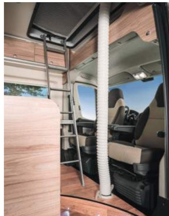
Un tubo flessibile per l'aria calda, opzionale, garantisce il riscaldamento del tetto apribile su HYMERCAR.
