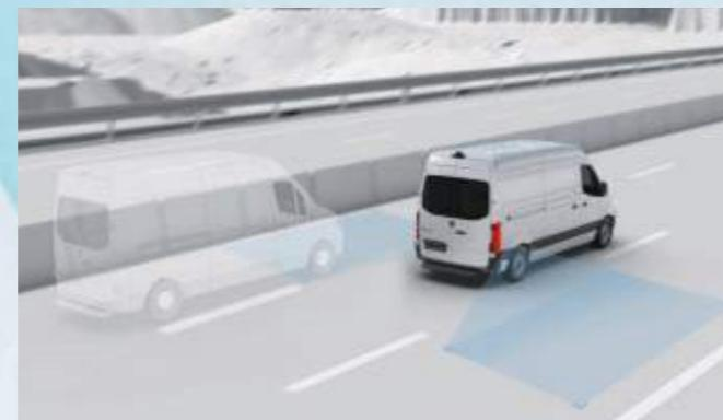
Il sistema di assistenza opzionale all'angolo cieco rileva i veicoli presenti nell'angolo cieco, avvisa il conducente tramite segnali visivi e acustici e sfrutta il sistema Rear Cross Traffic Alert per segnalare l'arrivo di altri veicoli dalla zona posteriore durante la retromarcia.
