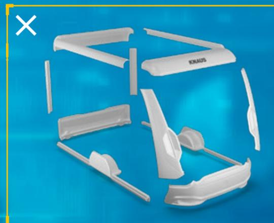
**Telai con tecnologia brevettata.** Abbiamo sviluppato un telaio autoportante nel quale i mobili possono fare i mobili, senza dover anche garantire la stabilità. In questo modo si aprono possibilità del tutto nuove ed una flessibilità impensabile per quanto riguarda il design delle tipologie abitative e degli spazi.
