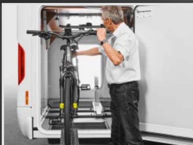
▲ Aumento dell'altezza di carico basta sollevare il letto posteriore all'interno con una mano, inoltre è disponibile la svasatura sul pavimento (per accogliere Pedelec con manubrio alto fino a 124 cm)
