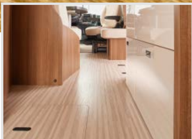
▲ Pavimento dell'abitacolo senza gradini dal retro fino alla cabina di guida
