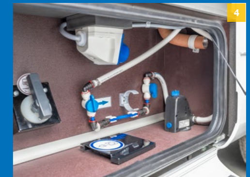
4. Il componente flessibile garantisce la fornitura d'acqua quando non avete un filtro di ricambio.
