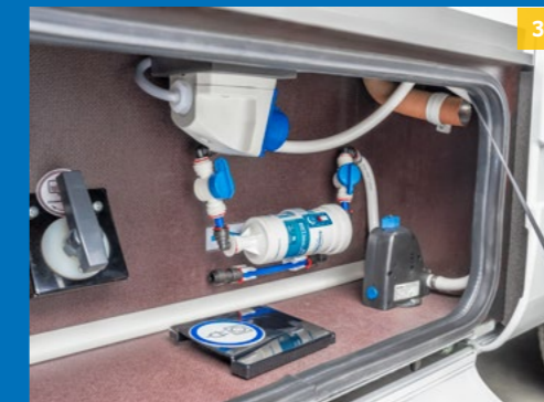
3. Il filtro scade dopo 6 mesi dalla data di installazione. Un apposito pulsante mostra il suo stato attuale.
