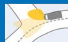
**Proiettori fendinebbia con luce di direzione.** Per garantire un'illuminazione ottimale della strada anche in curva, i fendinebbia sono dotati di una luce aggiuntiva che si irradia esattamente nella direzione di svolta del veicolo.
