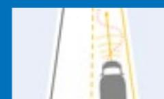
**Sistema attivo di cambio corsia.** Il sistema attivo di cambio corsia utilizza il servosterzo elettromeccanico per aiutare a mantenere il veicolo sempre in carreggiata. Unico nel settore degli autocaravan, il sistema attivo di cambio corsia del MAN TGE non aziona i freni ma regola le deviazioni, come nelle automobili, intervenendo sulla scatola dello sterzo e sulla pompa del servosterzo. Attivo a partire da una velocità di 65 km/h, garantisce il mantenimento della corsia di marcia.
