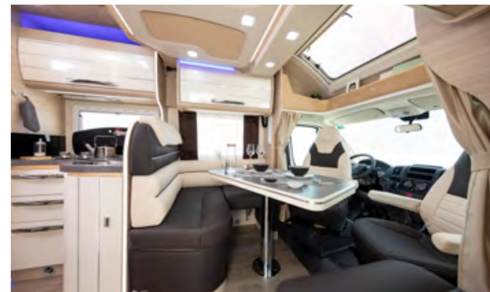
Sedili cabina ruotabili a 180° dotati di fodere coordinate con la tappezzeria. Sedute in poliuretano espanso a doppia densità.
