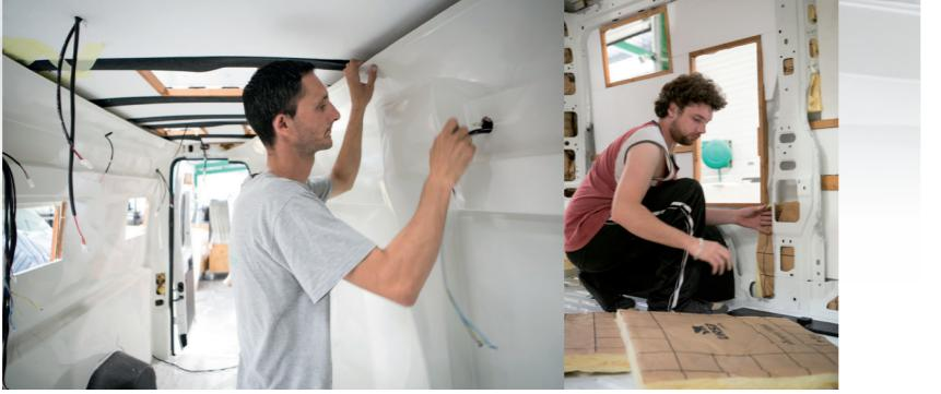
Isolamento termico ed acustico e soluzioni costruttive garantiscono un eccellente isolamento, punto di forza del prodotto Font Vendôme. Pareti, tetto, traverse, montanti e portelli sono rivestiti internamente con lana di roccia e polistirene. Il tetto ha un'ulteriore copertura in legno massello laminato.
