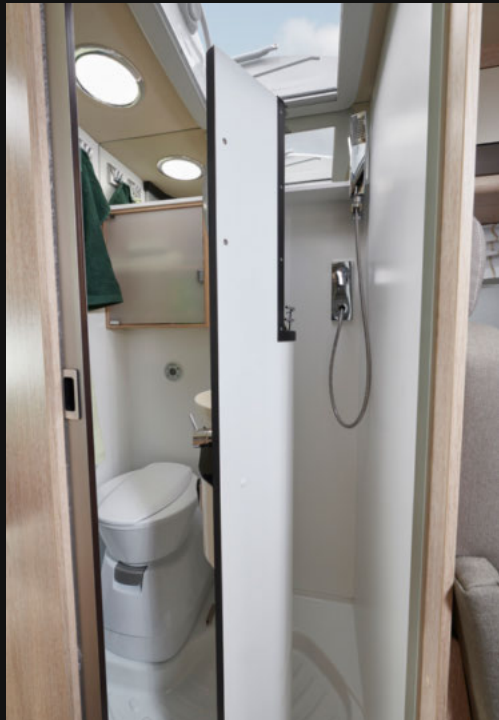
SCHWENKBAD Die schwenkbare Wand und die drehbare Toilette mit kratzfestem Ceramic-Inlay schaffen viel zusätzlichen Platz im Bad.
