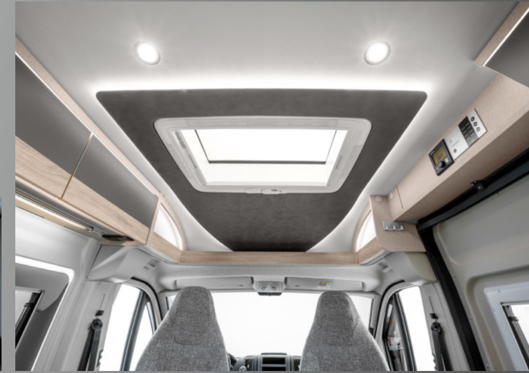
GROSSZÜGIGES RAUMKONZEPT MIT OFFENEM FAHRERHAUSHIMMEL Baldachin und Ablagefächer mit indirekter LED Beleuchtung.
