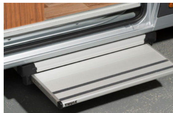
ELEKTRISCHE STUFE Für Aussteiger, die gerne bequem einsteigen: Auf Knopfdruck fährt die Trittstufe heraus.
