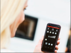
KABE Smart D Remote. KABE Smart D Remote* ermöglicht die Fernsteuerung der Bedientafel im Wohnwagen von einem beliebigen Ort mit Hilfe einer Smartphone-App. Das System basiert auf einem 4G-Router mit externen Antennen und einem mobilen Modem. Damit können Sie nicht nur die Heizung und die Beleuchtung steuern sowie Funktionen und Alarmmeldungen des Wohnwagens über das Handy kontrollieren, sondern Sie haben unterwegs auch Zugriff auf eine gute, drahtlose Internetverbindung.
