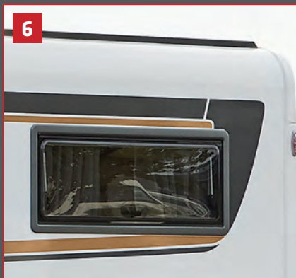
6 Finestre cellula Seitz S4 con telaio in PU privo di ponti termici e vetri isolanti.
