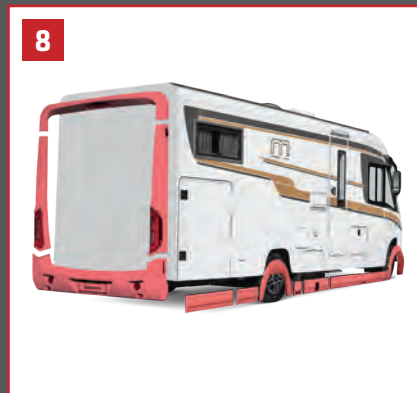
8 Design posteriore rielaborato con collegamento armonioso dell'arrotondamento del tetto/pareti laterali, facilità di riparazione in caso di danni grazie al telaio posteriore a 4 componenti.
