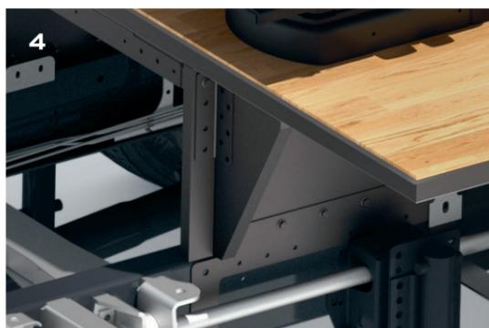
Il **pianale** serve per allineare il pavimento della cabina guida al pavimento dell'abitacolo completamente isolato. La sua robusta costruzione è composta da pannelli a sandwich in alluminio e lamiere smussate in acciaio per resistere alle forze in caso d'impatto.
