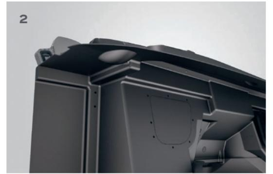
La **paratia**, una nuova costruzione di parete divisoria che, grazie alla sua alta stabilità e rigidità, soddisfa anche i più alti standard di sicurezza. La costruzione in materiale sintetico con rinforzi in fibra di vetro è stata ottimizzata grazie alle simulazioni realizzate con il computer.
