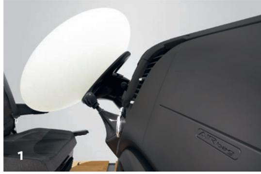
L'**airbag**, l'assoluta novità per la classe Liner: per una protezione ottimale in caso di impatto sono stati integrati gli airbag per il conducente e il passeggero. Il sistema è stato collaudato con i numerosi test e crash test frontali e laterali, tutti superati con successo.
