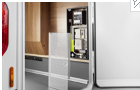
Centrale elettrica facilmente accessibile nel garage posteriore
