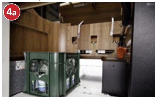
Comoda possibilità di carico del vano di stivaggio nel doppio pavimento attraverso un grande sportello esterno
