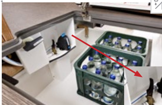
Centrale di controllo acque di scarico nella cantina nel doppio pavimento, accessibile anche dall'esterno tramite la porta della cellula
