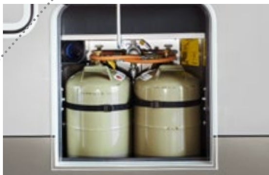
Vano bombole del gas "easy change", ribassato, con comando dello sportello azionabile con una sola mano, per una comoda sostituzione delle singole bombole
