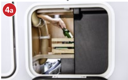
Comodo caricamento del vano di stivaggio nel doppio pavimento lato passeggero attraverso un altro sportello esterno
