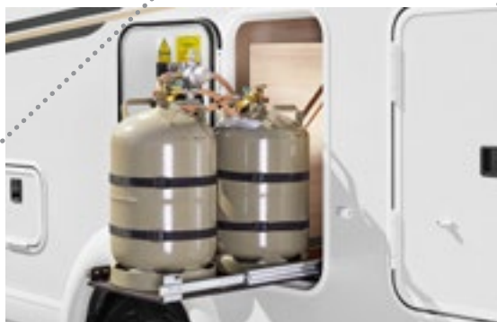
Vano bombole nella zona posteriore con comodo accesso tramite la porta del vano bombole. Optional: sistema comfort per l'estrazione vano bombole (I 138 DB, I 141 LE, I 143 LE)
