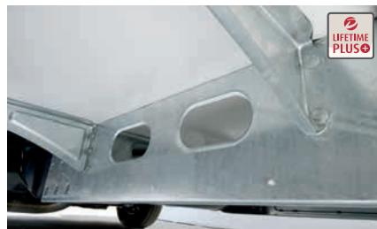
» Dethleffs Lifetime-Plus: il sottopavimento senza legno è rivestito di vetroresina, pareti laterali con strisce in PUR e isolamento XPS
