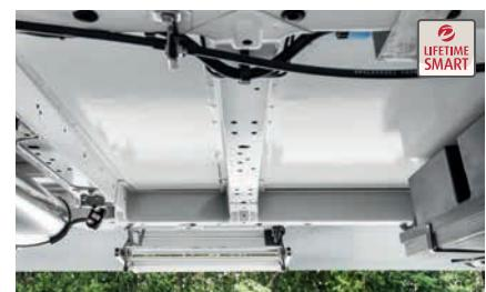
» Costruzione della cellula senza legno, Life time-Smart resistente alle infiltrazioni (rivestito in vetroresina) con serbatoio dell'acqua isolato e riscaldato.
