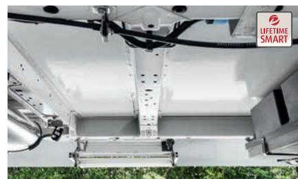
» Costruzione del pavimento Lifetime-Smart, priva di parti in legno a prova d'infiltrazioni (rivestito di VTR)
