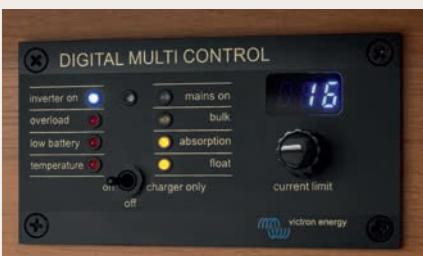
» Victron energy Digital MultiControl con pannello di controllo sopra la porta della cellula (optional)
