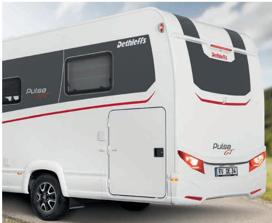
» Raccordo tetto parete posteriore arrotondato con moderno alettone con retrocamera integrata (optional) e terzo stop
