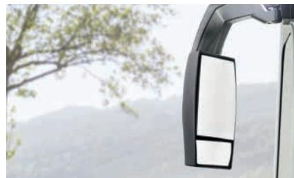
» Gli specchietti retrovisori in stile bus, elettrici, riscaldabili e montati lateralmente, assicurano un campo visivo ampio
