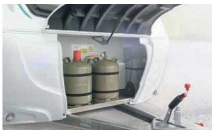
» Vano bombole gas per 2 bombole da 11 kg, pavimento anticorrosivo in alluminio
