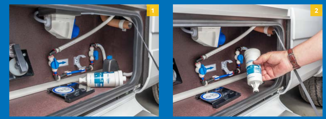
1. Il sistema viene installato alla consegna del veicolo e può essere utilizzato per un massimo di 6 mesi.
