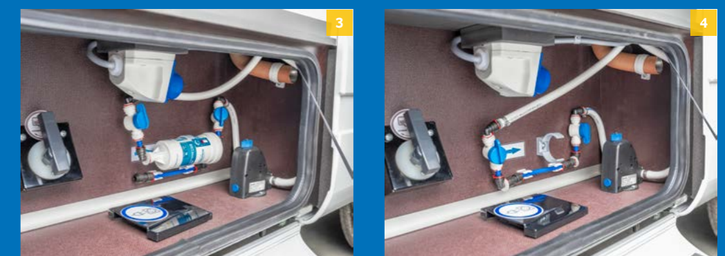
3. Il filtro scade dopo 6 mesi dalla data di installazione. Un apposito pulsante mostra il suo stato attuale.
