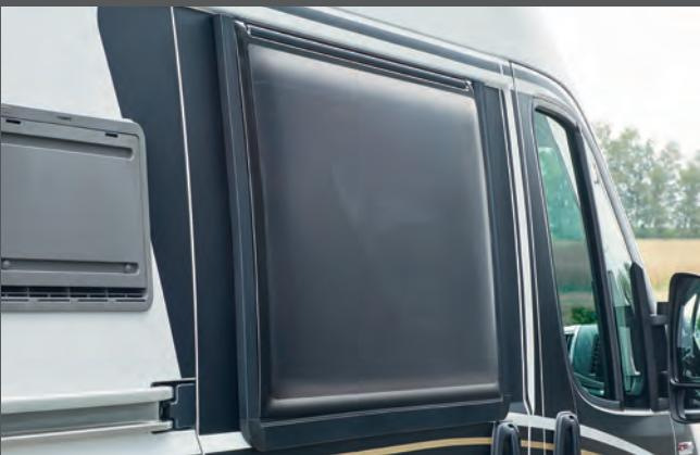
Finestra Premium Malibu con telaio perimetrale e doppio sistema di tenuta per la protezione da pioggia e flussi d'acqua, una maggiore sicurezza antieffrazione e una riduzione dei rumori durante il viaggio.\*
