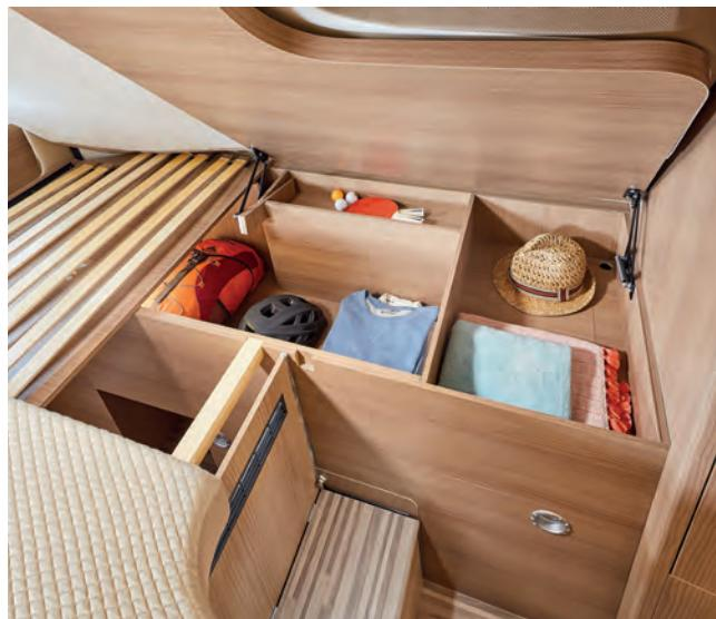
▲ L'armadio biancheria sotto il letto singolo longitudinale sul lato guida è comodamente accessibile grazie a un meccanismo di ribaltamento.
