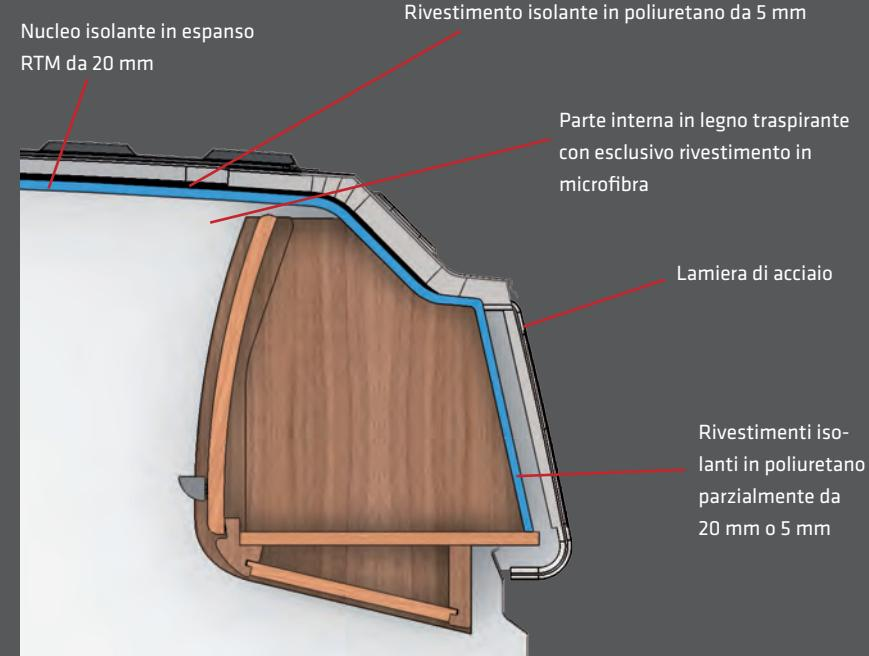
Malibu Van: importanti misure di isolamento termico per la carrozzeria
