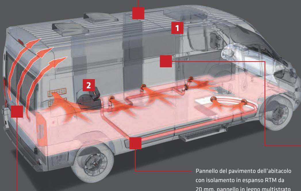
Parete posteriore/Porte posteriori: rivestite senza ponti termici con pannelli isolanti in poliuretano da 20 mm
