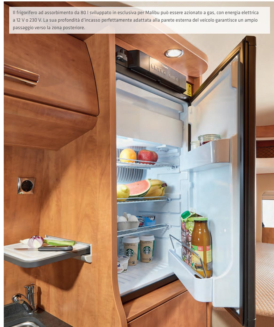
Il frigorifero ad assorbimento da 80 l sviluppato in esclusiva per Malibu può essere azionato a gas, con energia elettrica a 12 V o 230 V. La sua profondità d'incasso perfettamente adattata alla parete esterna del veicolo garantisce un ampio passaggio verso la zona posteriore.
