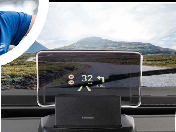
**Display head-up.** Il display head-up integrato garantisce una sicurezza ancora maggiore. Tutti i dati rilevanti vengono visualizzati nel campo visivo, così chi guida non deve distogliere lo sguardo dalla strada.
