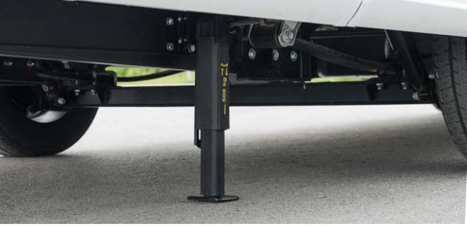
**Supporto a manovella nella zona posteriore.** Garantisce ulteriore stabilità e meno vibrazioni a veicolo fermo.
