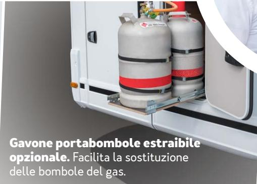
**Gavone portabombole estraibile opzionale.** Facilita la sostituzione delle bombole del gas.
