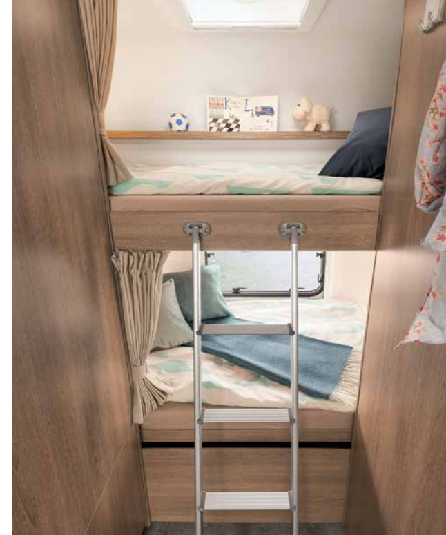
Il letto inferiore può essere ripiegato, creando uno spazio di stivaggio posteriore ben utilizzabile per tutta la larghezza del veicolo. • A 5887
