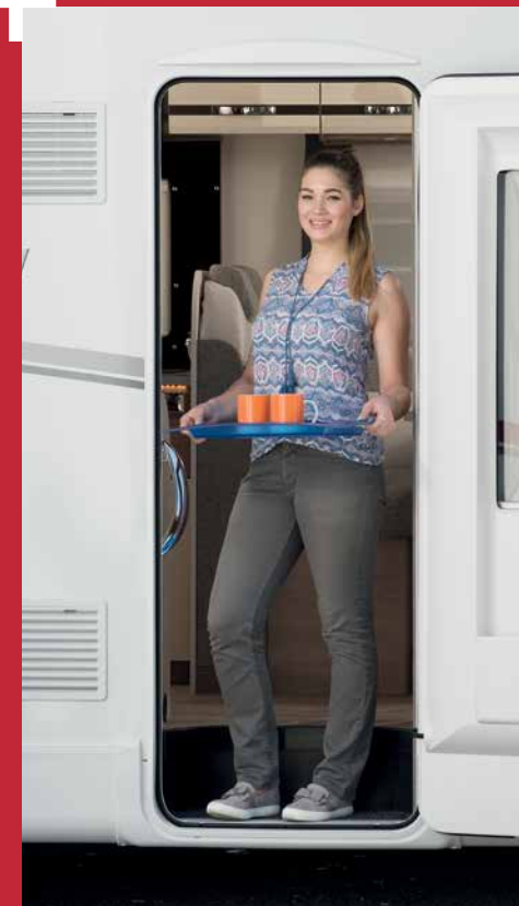
Porta della cellula larga 70 cm con finestra e chiusura centralizzata
