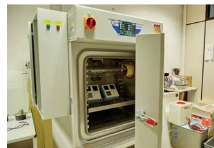
Test prestazionali sulla componentistica impiegata. Durabilità dei materiali, resistenza alle sollecitazioni, affidabilità e conformità alla regolamentazione europea nella progettazione del blocco delle cinture di sicurezza.
