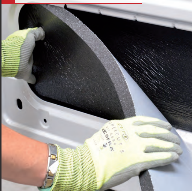
2 Pareti laterali e montanti della carrozzeria rivestiti senza ponti termici
