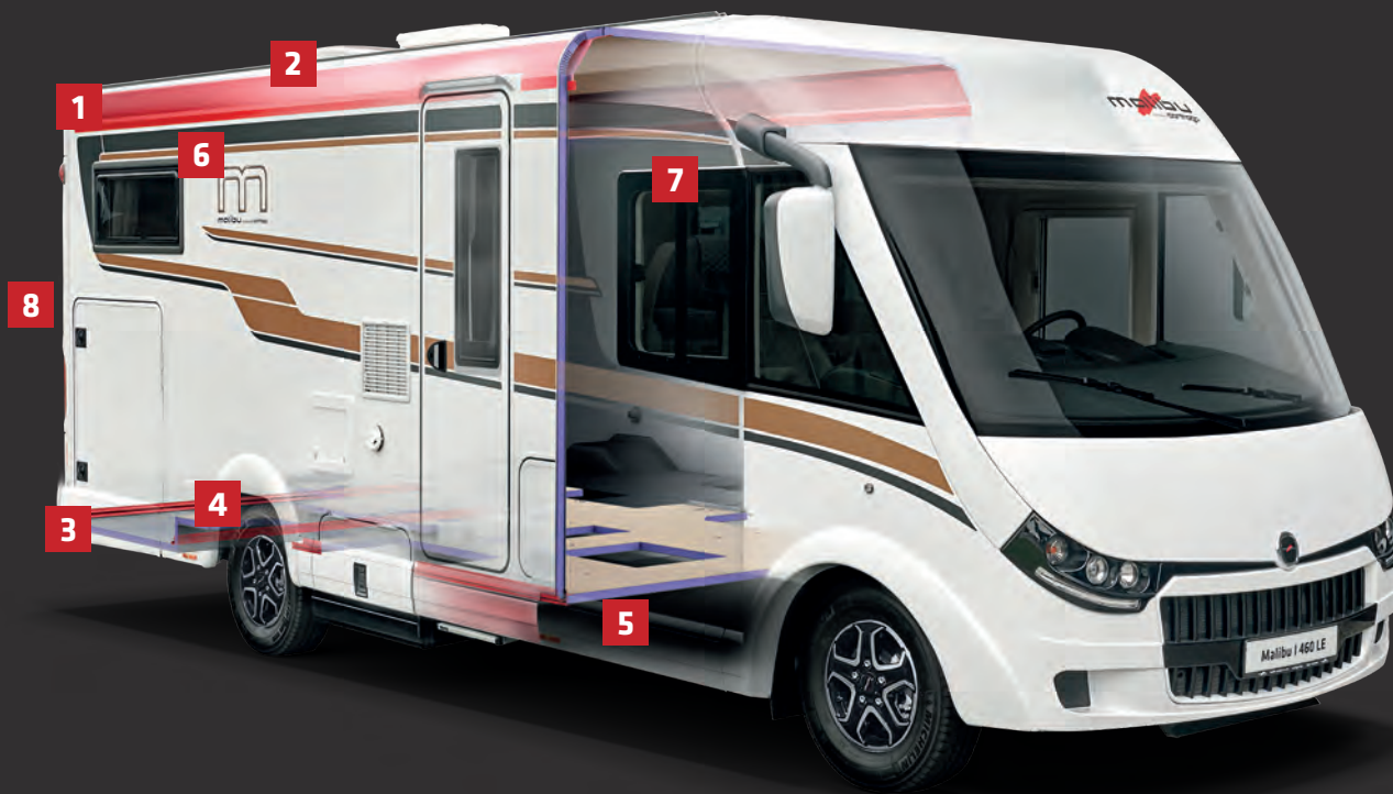
1 Giunzione parete/tetto priva di ponti termici
