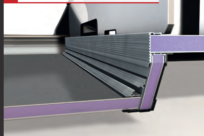
4 Ribassamento extra basso del garage posteriore
