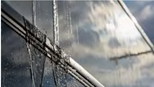
Test di impermeabilizzazione contro le infiltrazioni al 100% dei veicoli usciti di produzione, prima della consegna.
