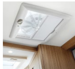
V3009011 Oblò con ventola sopra la cucina
