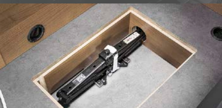
19 Martinetti nel vano incassato sotto il tavolo
