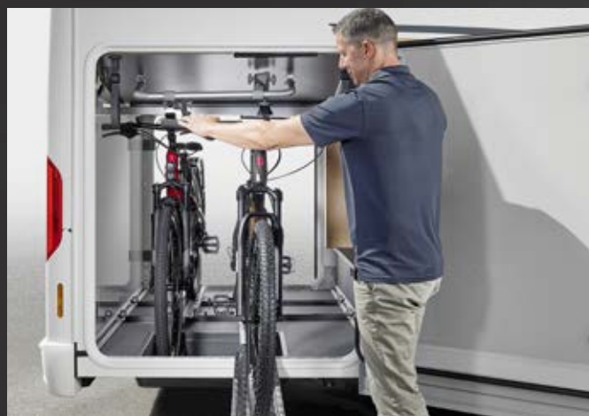
Facile carico di una Pedelec o uno scooter tramite il sistema di spinta con binario agganciabile
