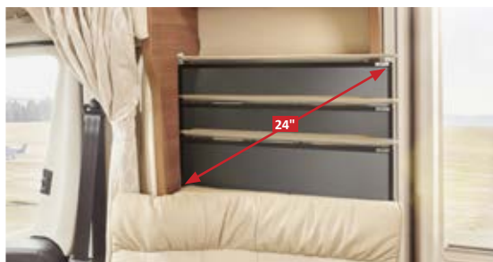
Sistema di estrazione TV "Quick-up"* dietro lo schienale
