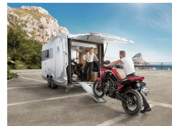
**DESEO 400 TR.** Il portellone posteriore, di dimensioni 160 x 180 cm, e la stabile rampa che, durante la corsa, è fissata per mezzo di una barra e di una chiusura girevole, rendono le operazioni di carico particolarmente facili. È possibile avere anche una seconda rampa di carico opzionale.
