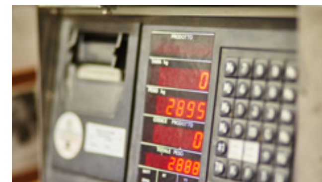
Pesatura elettronica del 100% dei veicoli prima della consegna e certificazione scritta del peso al cliente finale.
