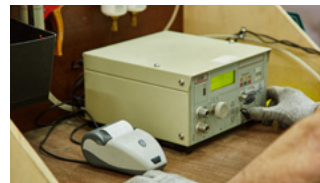
Collaudo impianti gas da personale certificato secondo protocollo tedesco DVGW.
